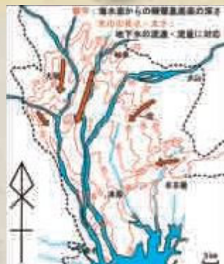
▲濃尾平野の「第1帯水層」における地下水流系の例(森原、1976を簡略化)地下にある谷に沿って流れている様子がわかる。
